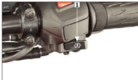
(1) Interruptor de arranque eléctrico
