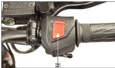
(2) Interruptor parada del motor
