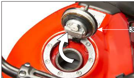
(3) Tapa del tanque de combustible
